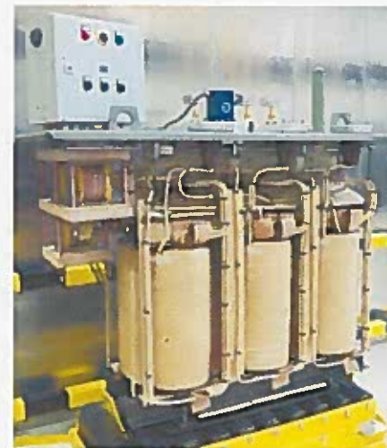
"Smarte" Neuerung: Regelbarer Ortsnetztransformator (RONT)
